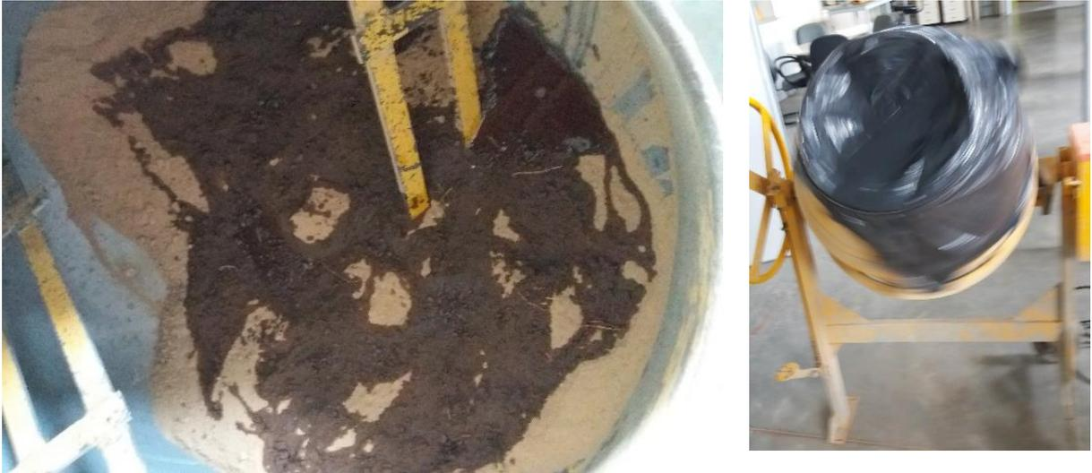
Figura 3: procedimento de homogeneização na contaminação do solo.
