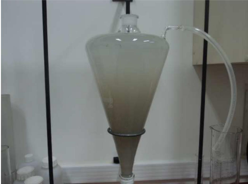
Figura 8 – Vista em detalhe do separador sólido-líquido (decantador).
