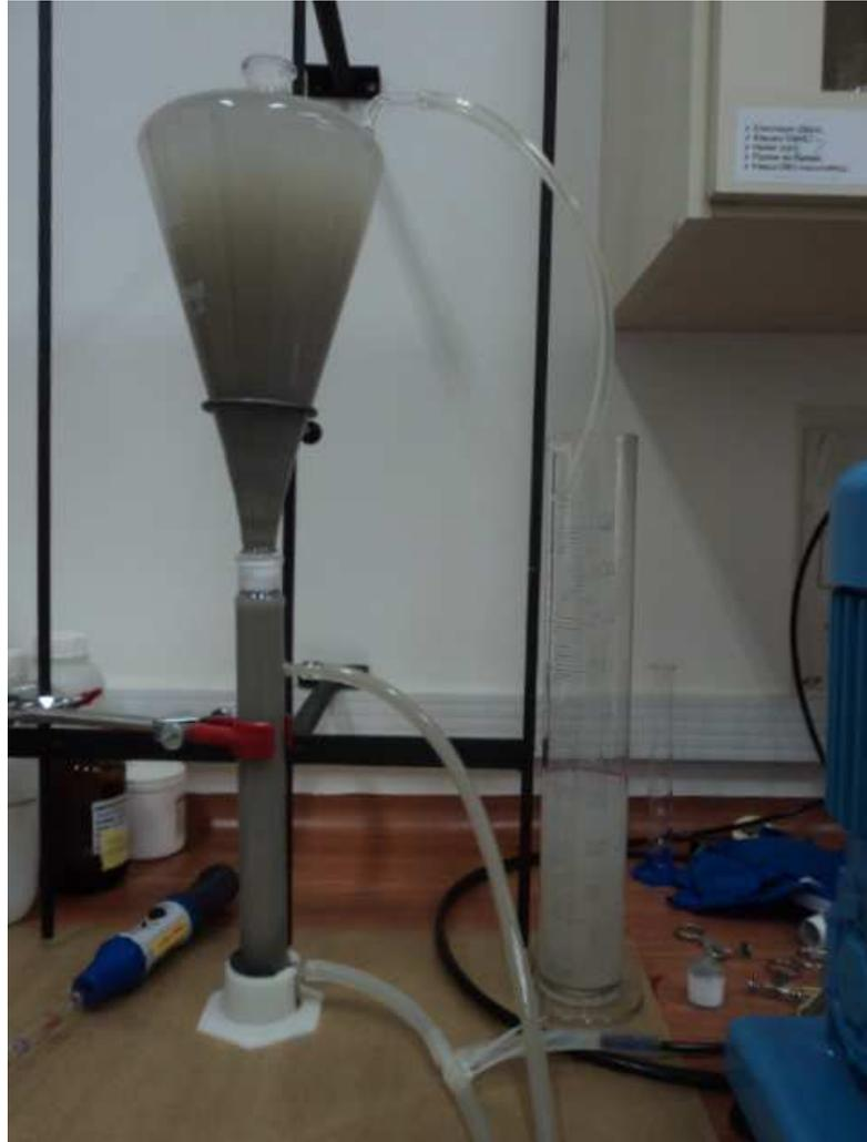
Figura 7 - Detalhe do reator e separador sólido-líquido.
