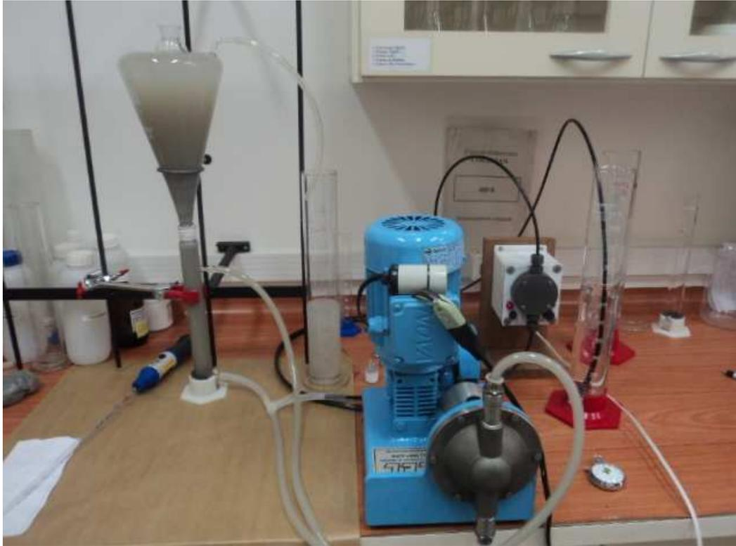
Figura 6 - Vista do sistema de leito fluidizado montado e em operação. Reator, separador sólido-líquido e bombas de alimentação (branca) e reciclo (azul).
