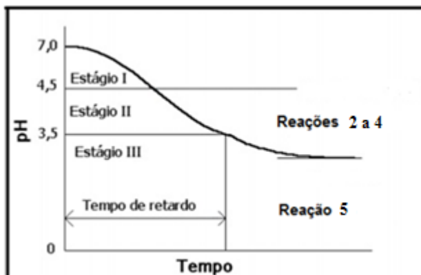
Figura 1- Estágios de formação de drenagem ácida. Fonte: Adaptado de FAGUNDES, 2005.
