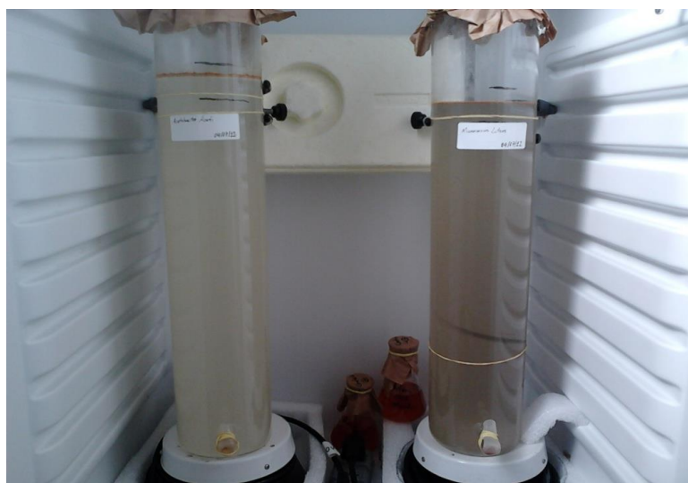
Figura 10 - Experimento após o bioprocesso em estufa com aeração forçada, agitação e temperatura constante de 32°C. Fonte: Autoria própria, 2012.
