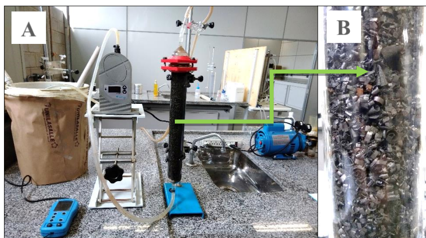
Figura 10 – (A) bancada de execução do processo Fenton Heterogêneo. (B) detalhe dos cavacos na coluna.
