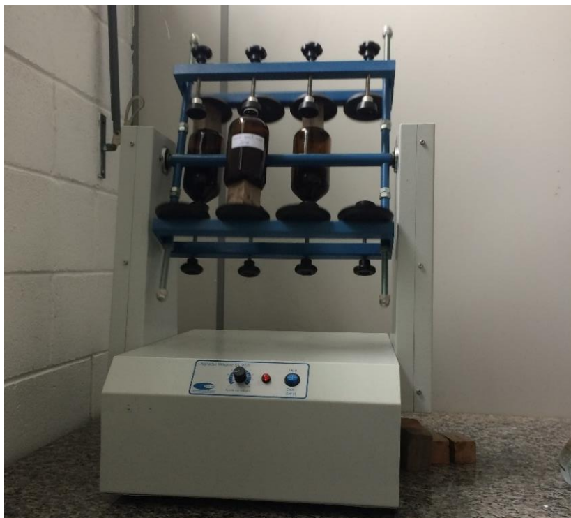
Figura 9 – Amostras em processo de ativação no equipamento agitador rotativo do tipo Wagner
