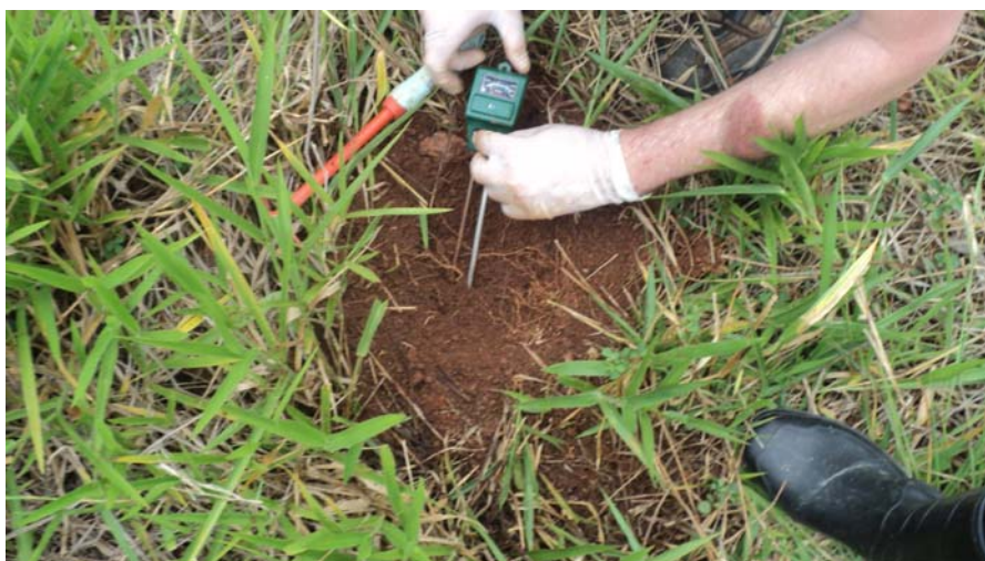
Figura 28 - Aparelho para análise de pH in loco
