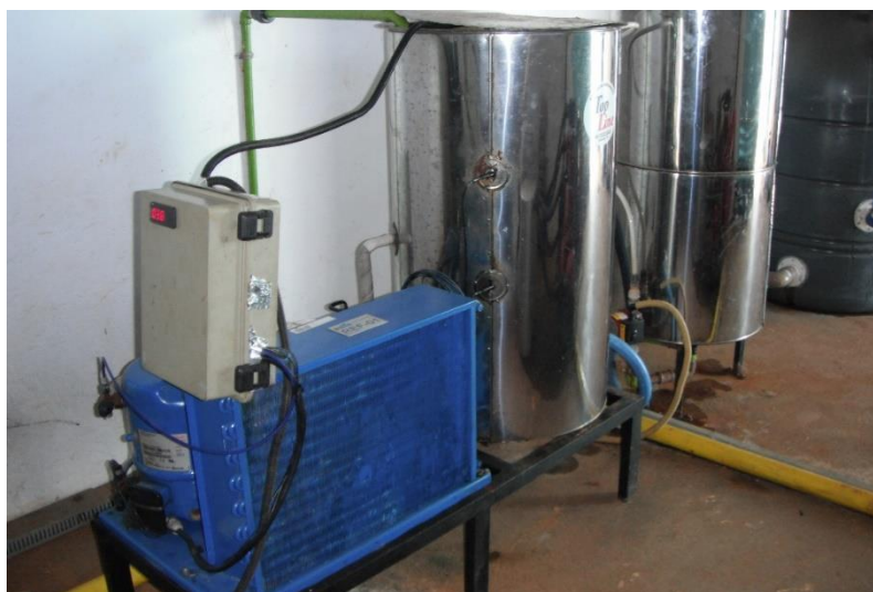
Figura 15 – Sistema de limpeza do biogás da Granja UPL de Palma Sola/SC
