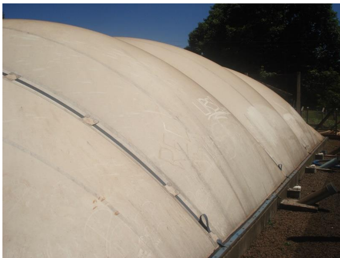
Figura 28 – Lagoa coberta, similar ao biodigestor modelo canadense ou da marinha
