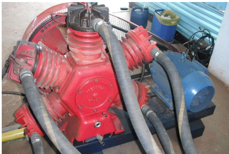
Figura 18 – Compressor de biogás
