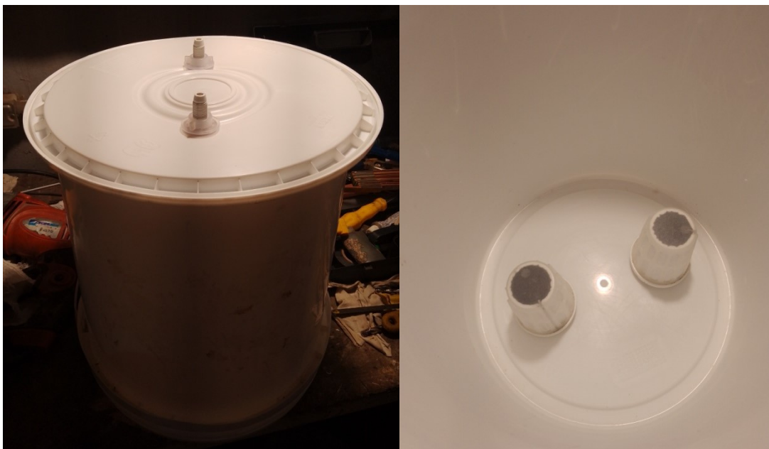
Figura 3: Imagens da construção do filtro (parte interna). À esquerda lado externo e à direita lado interno mostrando os elementos filtrantes. Fonte: autoria própria (2024).
