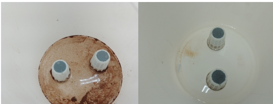
Figura 4: Imagens da construção do filtro. À esquerda, o filtro com solução de flúor (9 mg/L) misturado com engaço de uva, e a direita, a solução de flúor (5 mg/L) misturado com a farinha de osso. Fonte: autoria própria (2024).
